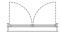
porte fenêtre double vantail à volet roulant
