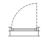
porte fenêtre simple vantail à volet roulant
